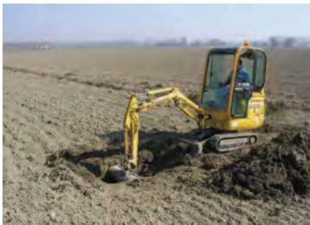
Fig. 2.2: Scavo di un profilo di suolo con miniescavatore.
