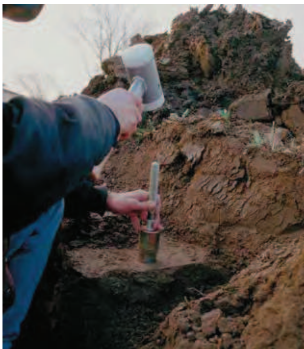
Fig. 7.4: Prelievo di campioni indisturbati con cilindri di volume noto.
